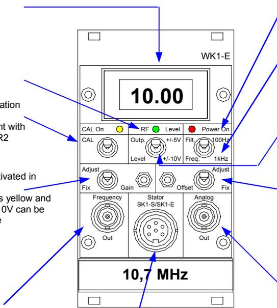
**Stator-Connection for SK1-S2/-S4/-E1**
